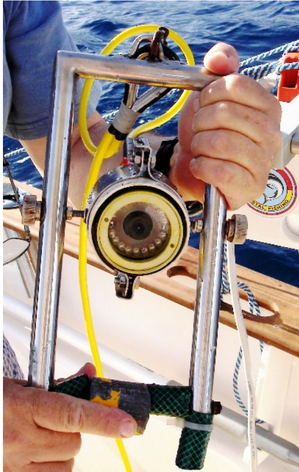
Figura 8. Aspecto de la cámara submarina con su bastidor y el lastre (el cilindro de plomo sujeto con los dedos).
